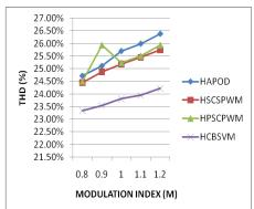
Fig: 20. Modulation index versus % THD
