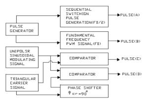
Fig: 8. Base modulation generator – HPSCPWM
